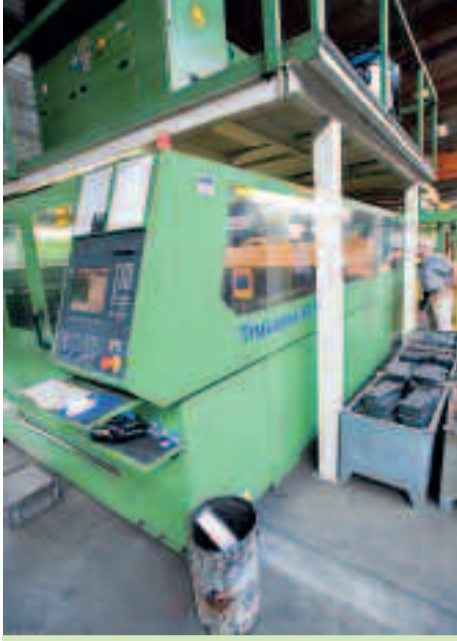
Eén Trumpf-lasersnijder met automatische plaat in- en uitvoer levert de klok rond stukken af. (foto: LDS)
